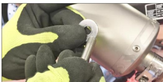
**ITA** Fissare la staffa di supporto silenziatore al telaio usando la vite (7), rondella (2) e dado (6) in dotazione senza serrare
