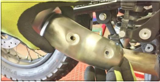
**ITA** Montare il paracalore originale e fissarlo con le viti originali
