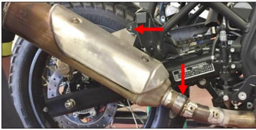
**ITA** Allentare le viti della fascetta innesto del silenziatore, svitare la vite della staffa di supporto silenziatore e rimuovere lo scarico originale.
