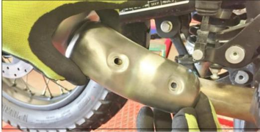
**ITA** Iniziare rimuovendo il piccolo paracalore svitando la vite di sostegno
