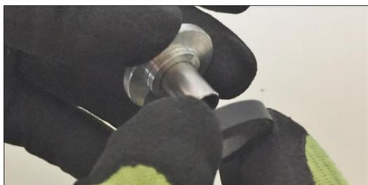
**ITA** Posizionare il distanziale in alluminio (3) sulla rondella silent-block (4) come in foto e posizionarli nel lato interno della staffa supporto silenziatore in corrispondenza del foro. Posizionare il distanziale silent block (5) nel lato esterno della staffa in corrispondenza del foro.
