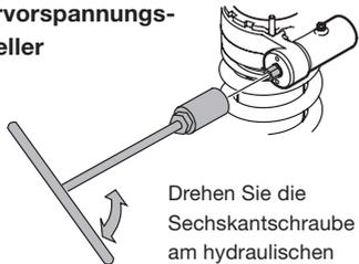
Drehen Sie die Sechskantschraube am hydraulischen Verstellregler. Drehen Sie im Uhrzeigersinn wenn Sie die Federvorspannung erhöhen und dagegen, wenn Sie diese senken wollen.
