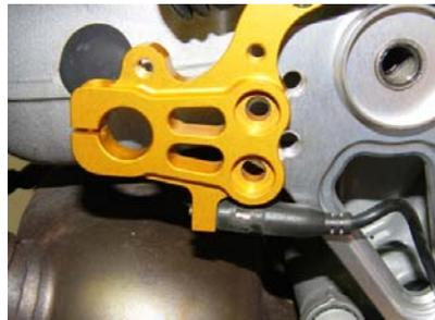
MONTARE IL MICRO DEL FRENO POSTERIORE DI SERIE
