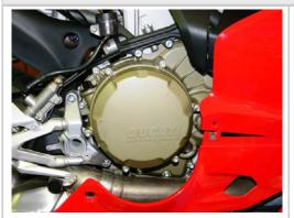
POSIZIONARE LA MOTO SUL CAVALLETTO LATERALE PER EVITARE LA FUORI USCITA DELL' OLIO MOTORE, APRIRE LEGGERMENTE LA CARENATURA
